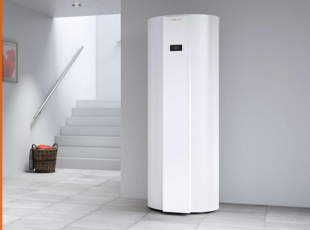
Diese Wärmepumpen können entweder der Umluft, der Außenluft oder der Abluft Wärme entziehen. Für eine Umluft-Warmwasser-Wärmepumpe eignen sich unter anderem Kellerräume, die in den Wintermonaten eine konstante und relativ hohe Temperatur haben. Während des Betriebs wird die Temperatur im Kellerraum um etwa zwei bis vier Grad abgekühlt. Ist die Temperaturdifferenz zwischen der Wärmequelle und dem Heizsystem klein, arbeiten Brauchwasser-Wärmepumpen äußerst effizient.
